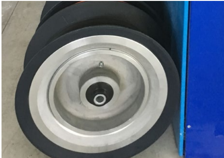
Ersatzteilhaltung – hier Seilrollen Quelle: StMB
