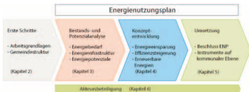
Phasen bei der Erstellung eines Energienutzungsplans
