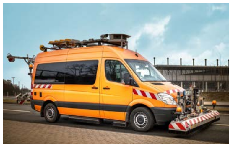
Multifunktionales Messsystem zur Erfassung des oberflächigen Fahrbahnzustands
