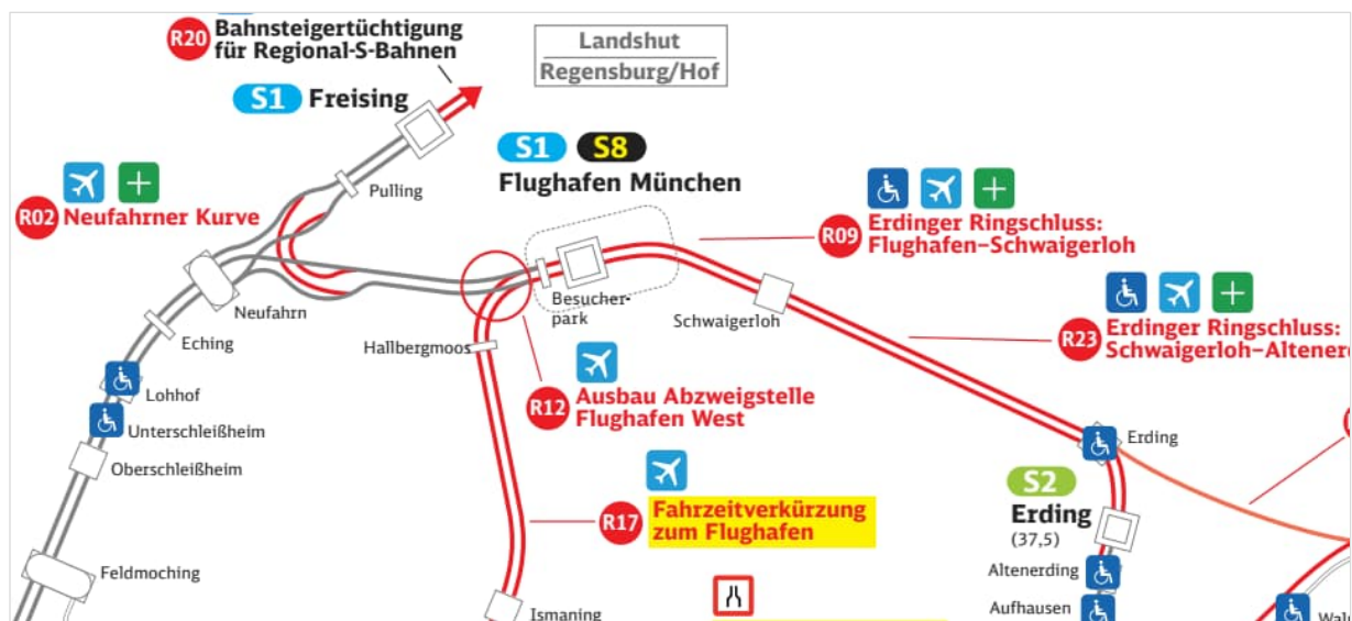
Abbildung 1 R-Maßnahmen im Untersuchungsraum (Quelle: DB Netz AG)
