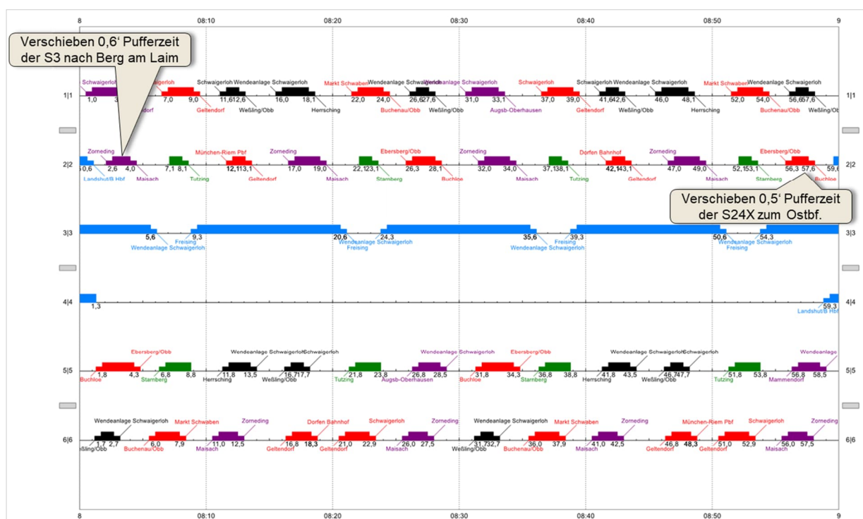
Abbildung 10 Gleisbelegung Leuchtenbergring in der Variante 3
